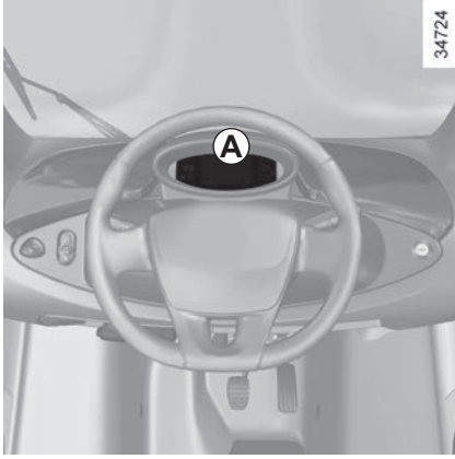
Gösterge tablosu A: Kontak açıldığında ışığı yanar.
