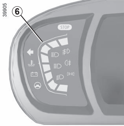
Soğutma sıvısı sıcaklık göstergesi 6
